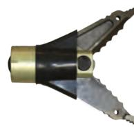
Позволяет перемещать, раздвигать и приподнимать различные предметы при незначительном зазоре между опорой и грузом, работать в труднодоступных местах, обеспечивая большее усилие.
