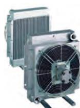
Маслоохладители предназначены для охлаждения рабочей жидкости, сливающейся в бак. Применяются как правило для технологического оборудования, работающего длительное время, либо для станций с баком не позволяющим обеспечить охлаждение естественным способом. Представляет собой радиатор с вытяжным вентилятором 24В.
