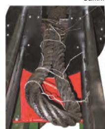
Петля каната внутри поворотного зажима
