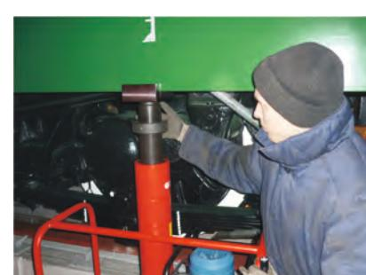
Домкраты передвижные «Энерпред» предназначены для быстрого и безопасного подъема локомотивов в условиях цеха без использования дополнительных средств при проведении ремонтных работ и технического обслуживания. Управление осуществляется по радиоканалу с пульта дистанционного управления или вручную.
